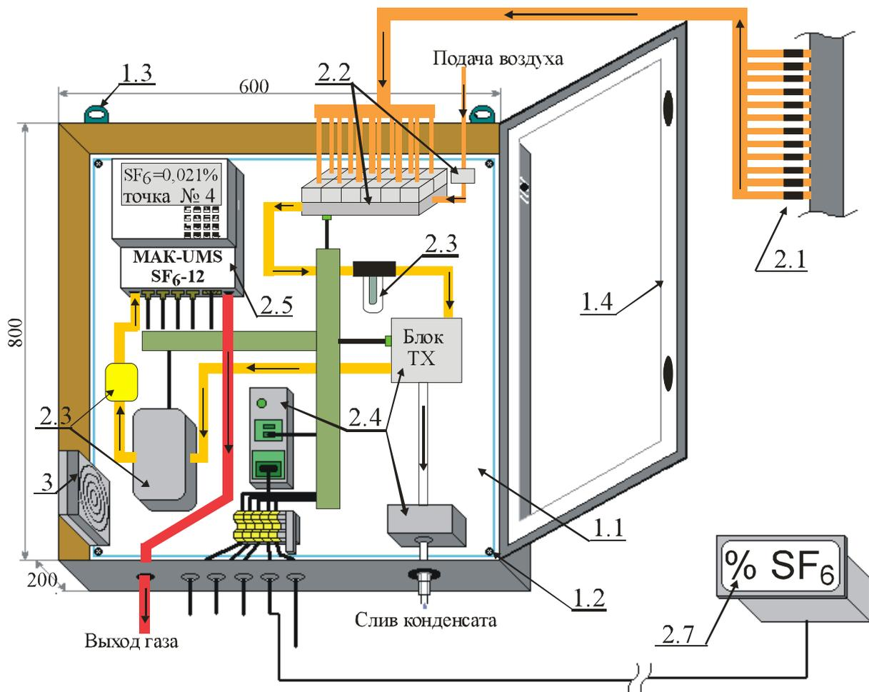
**Рис. 1. ИК-анализатор «МАК-UMS-SF<sub>6</sub>-12».** Монтаж «под ключ» в стальной пылевлагозащищенный шкаф 800x600x200 фирмы «SAREL» (Франция).
