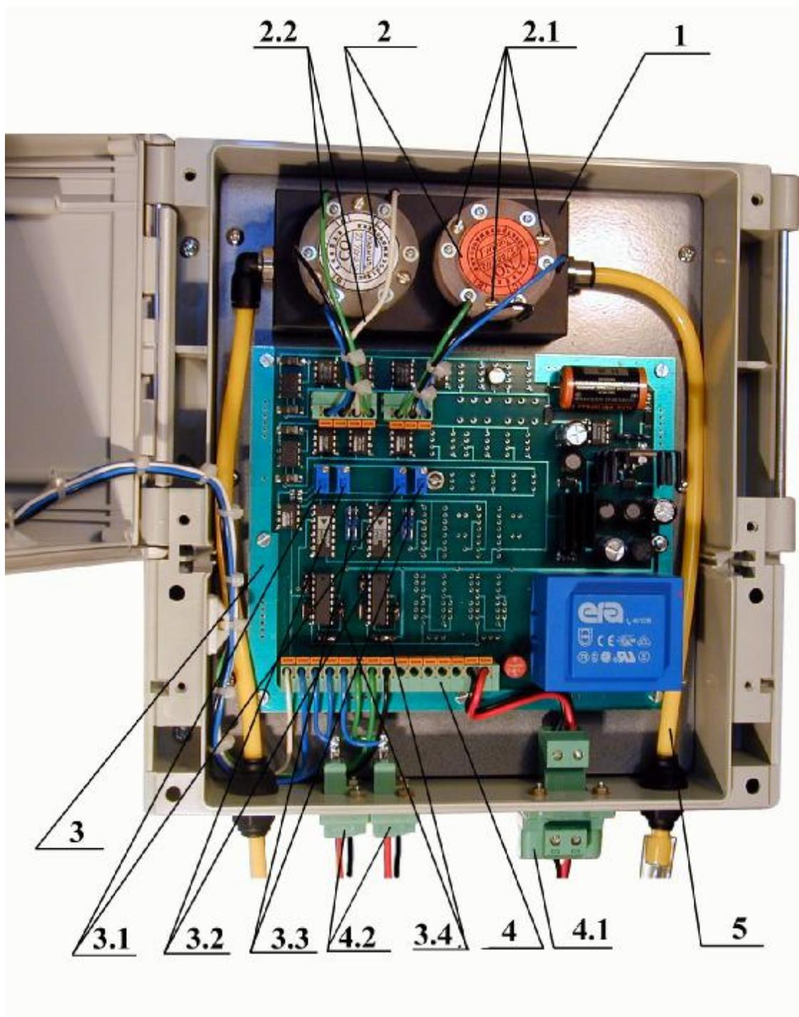
**Рис.2 Вид «МАК-2000» изнутри (условно приведен 2-х компонентный аналоговый СО/НО вариант).**
