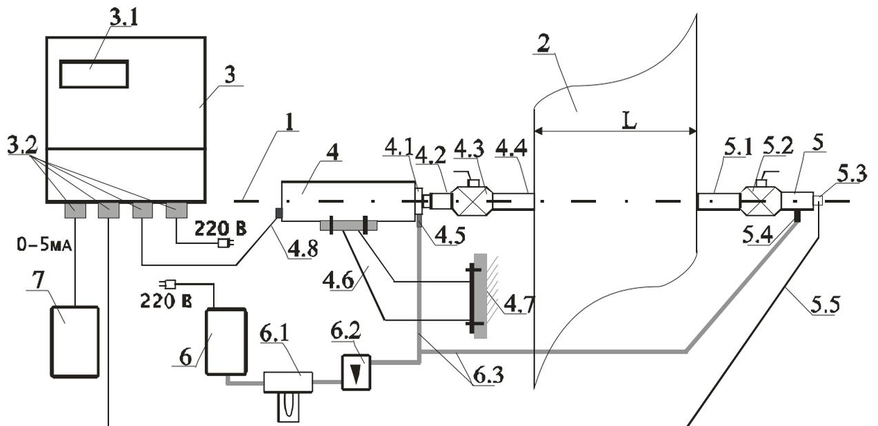
**Рис.1. Схема электрических и газовых соединений «АСД-04» для рабочих условий применения и калибровки.**
